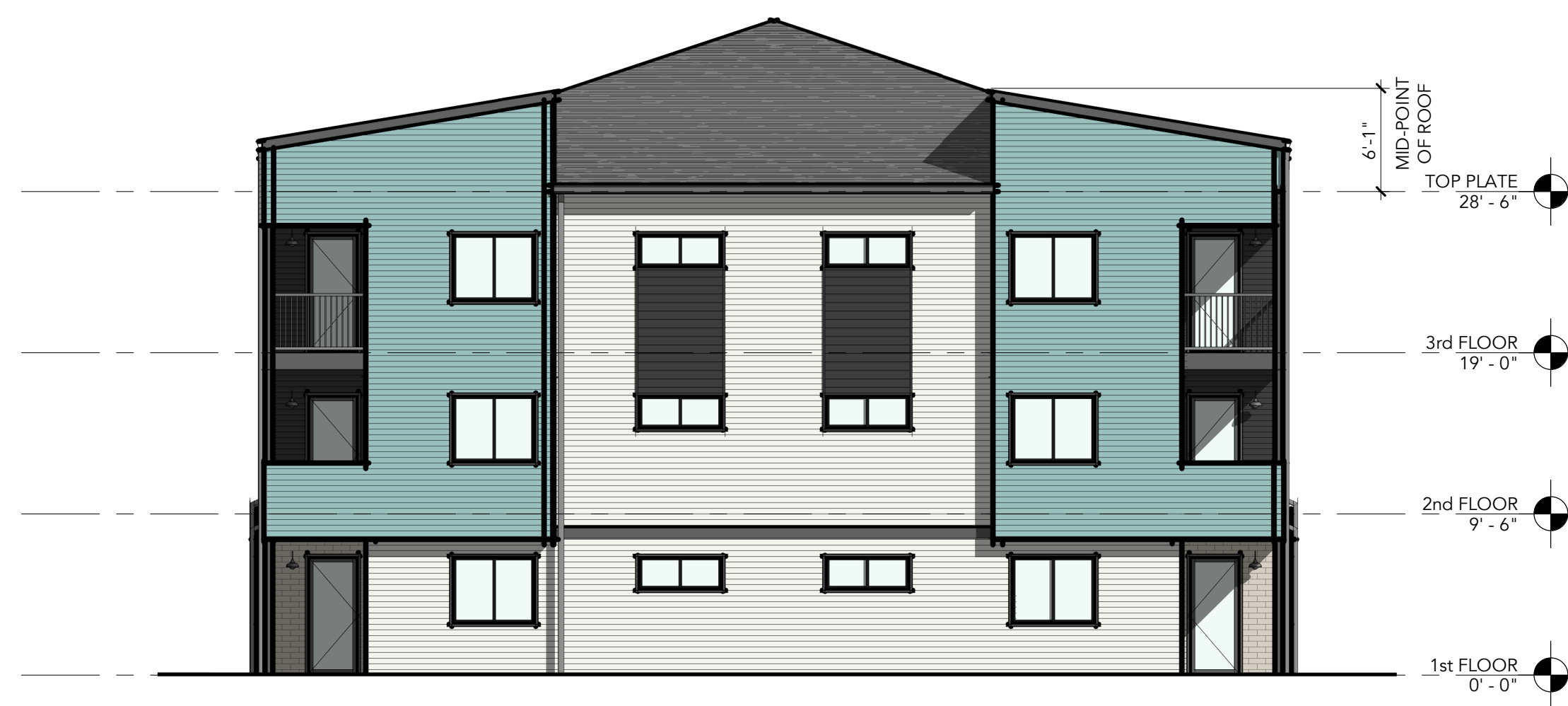
2 SIDE ELEVATION SCALE: 1/8" = 1'-0"
